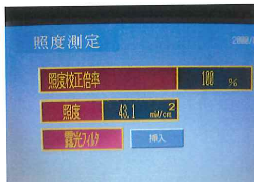
照度測定結果:43.1mW/cm 2
