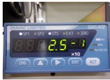
・セット到達圧力 : 2.5 \times 10^{-1} Pa
